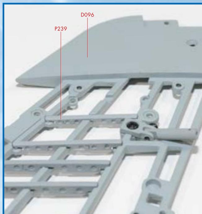
**1** На этом этапе сборки вам потребуются детали, полученные с этим номером, и узел деталей из №91. Установите нервюру (P238) на каркас левой консоли крыла (D096), как показано на снимке. Обратите внимание на взаимное расположение деталей P238 и D096.
