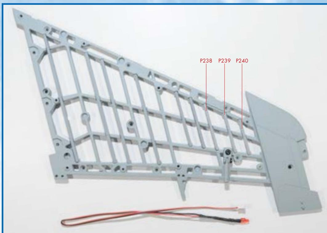
**3** Затем установите серво (P240) на каркас левой консоли крыла (D096), как показано на снимке.
